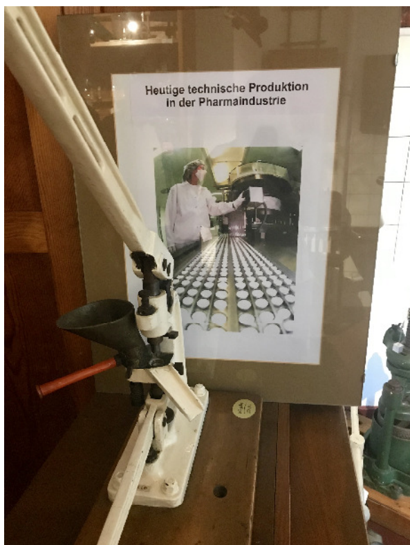
Die manuelle Tablettenpresse im Schwanen-Apotheken-Museum und zum Vergleich ein Foto der industriellen Tablettenherstellung (Foto: S. Preiser-Marian, Stadt Bad Münsterneifel)
